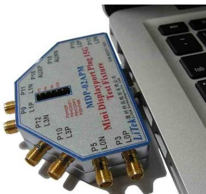
Fig2: Mini Display-port Plug Test Fixture plugged into Mini Display-port receptacle NB
